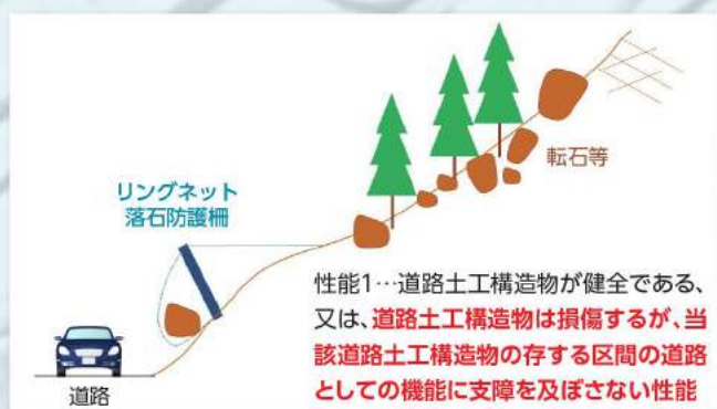
落石防護柵の要求性能区分イメージ (性能1)
