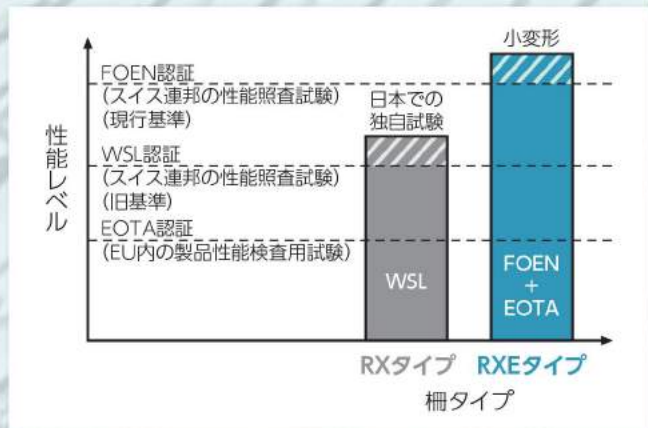
実物大実験の認証レベルと柵の性能の高さ
